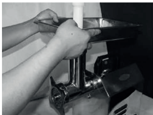
Rys. 1. Zdjąć tacę na mięso, jednocześnie przekręcając i pociągając ją do góry
