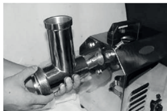
Рис. 6. Снять горловину целиком, удерживая прибор при ослаблении стопорных гаек.
