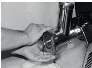
Рис. 2. Отвинтить стопорную гайку.
