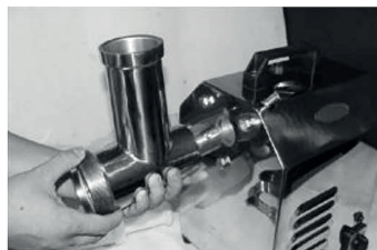
Rys. 6. Zdjąć całą gardziel, przytrzymując urządzenie podczas odkręcania nakrętek blokujących.
