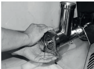
Rys. 2. Odkręcić nakrętkę blokującą
