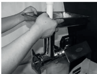
Рис. 1. Снять лоток для мяса, одновременно поворачивая и потянув его вверх.
