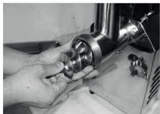
Rys. 4. Ostrożnie zdjęć ostrze tnące, uważając na ostre krawędzie.
